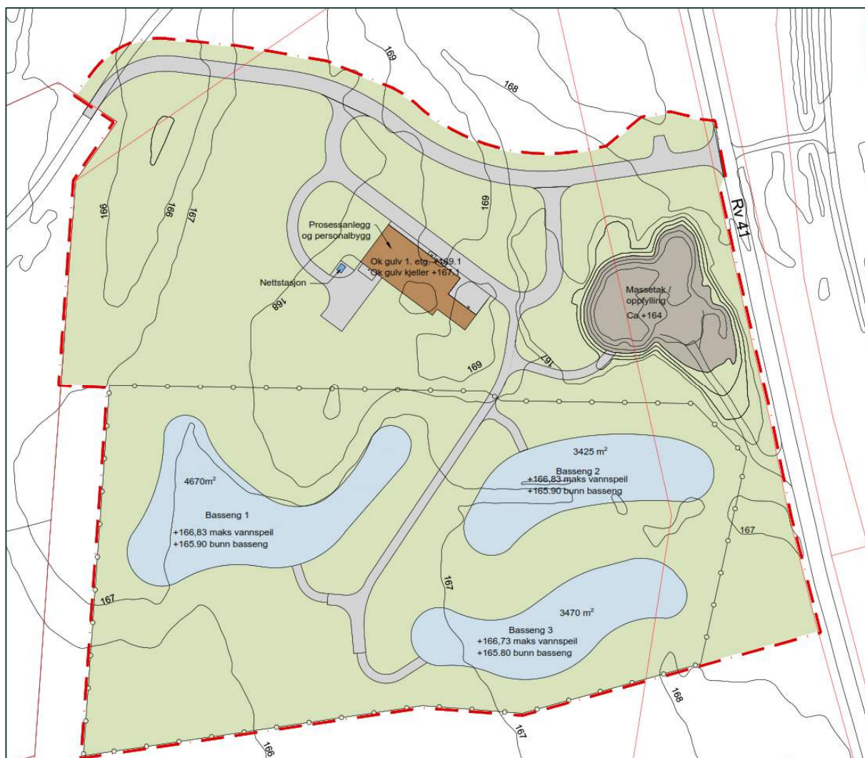
Figur 9-7: Utsnitt av tegning som viser omriset av nye Langmoen RA i Nissedal kommune med infiltrasjonsanlegg.
