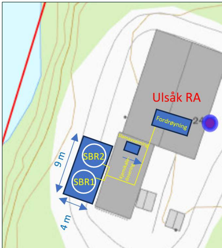
Figur 6-3: Forslag til plassering av et nytt SBR-trinn på Ulsåk RA.
